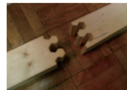
「継ぎ手の引張実験」での学生案2：六角継手 (Pmax: 12.5kN)
