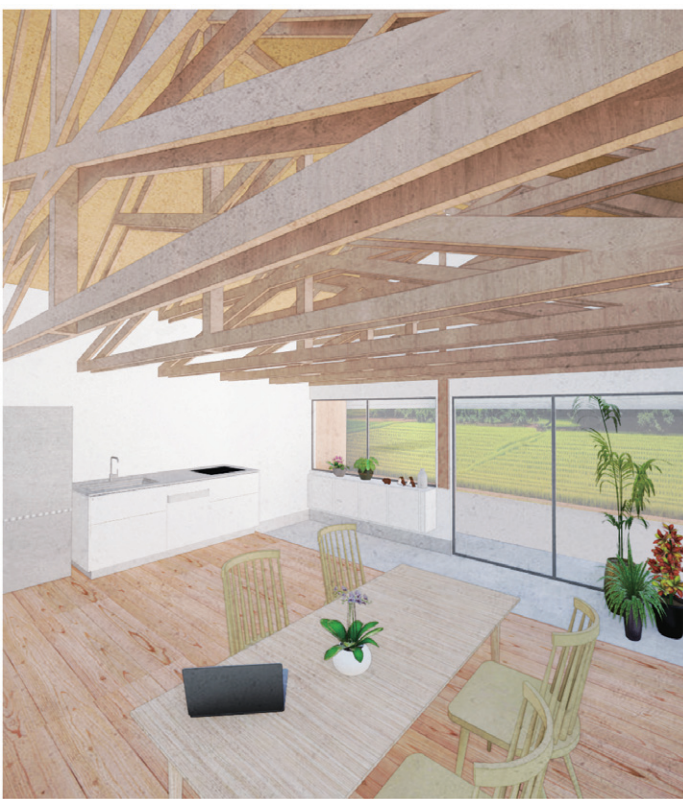
能登の杉を使った屋根架構が室内にも見える
