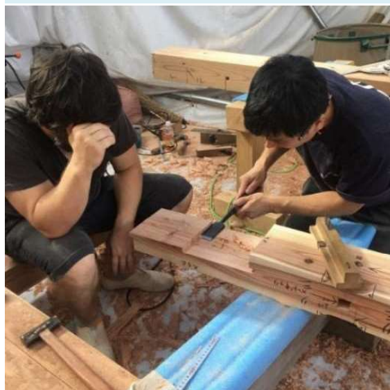
OJT風景(写真は現場での手刻み指導の図)
