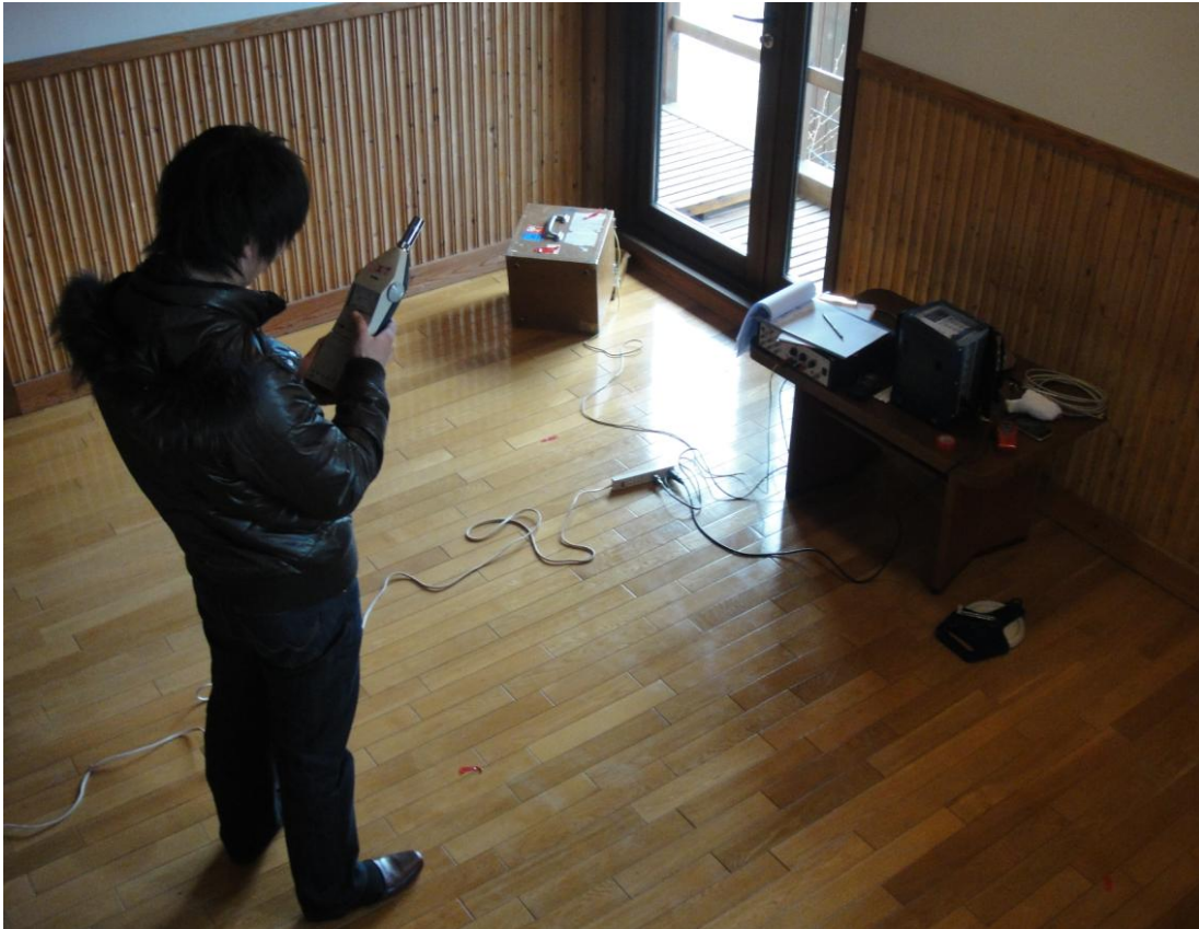
写真4 林業機械化センター 研修棟 設計資料室(音源室) 2 F 室間音圧レベル差測定風景
