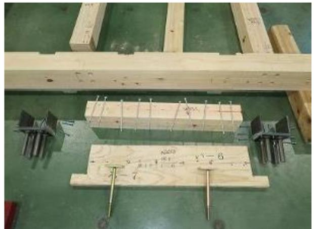
土台側受け材の破壊状況
