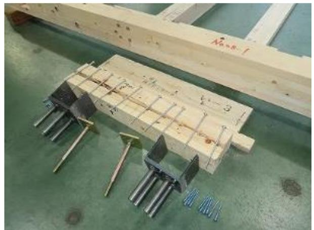
受け材の縦方向の割れ（端部は横方向割れも）
