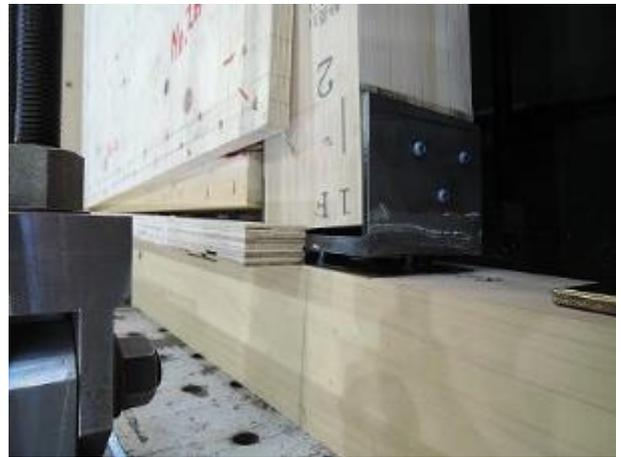
受け材の横方向の割れ、ビスの抜け
