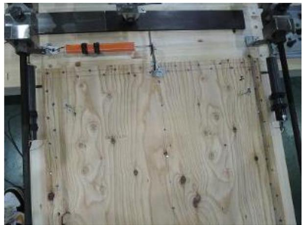
柱頭側の破壊状況
