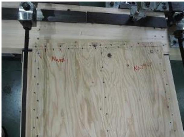
柱頭側の破壊状況
