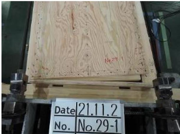
柱脚側の破壊状況
