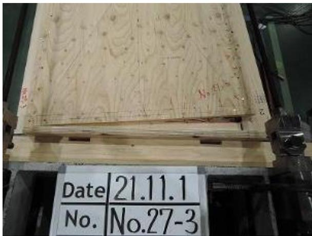
柱脚：面材の回転挙動による受け材の割裂
