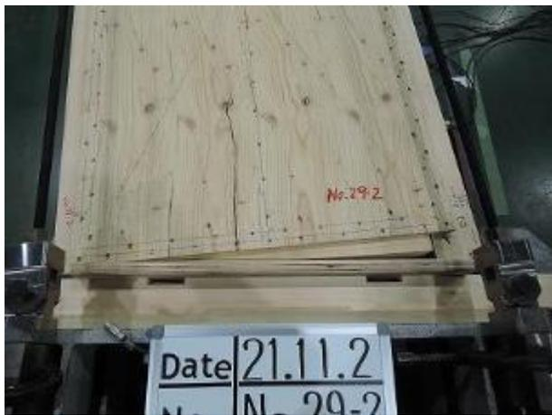
柱脚側の破壊状況
