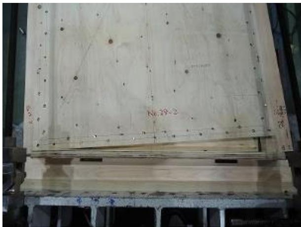
柱脚側の破壊状況
