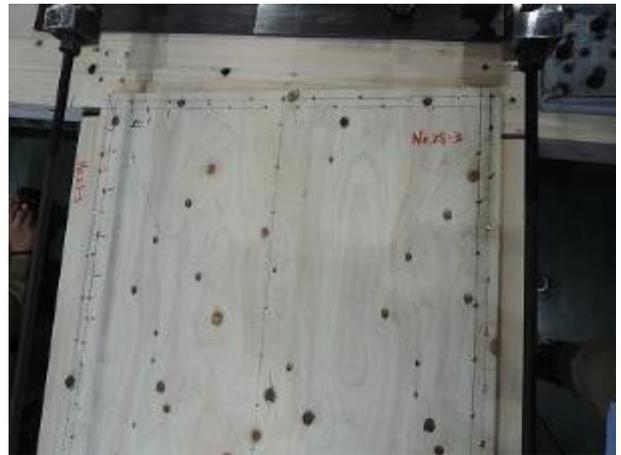
柱頭側の破壊状況
