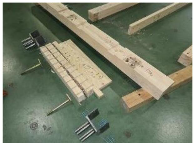
土台側受け材の破壊状況
