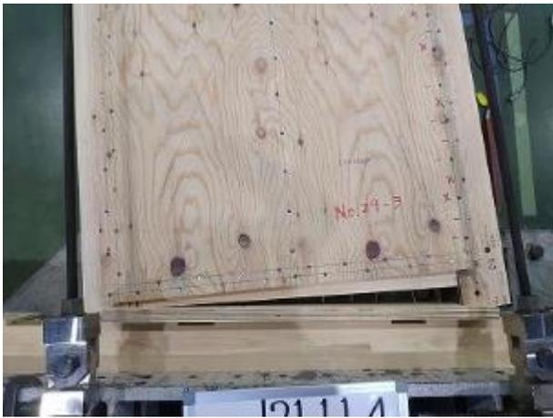
柱脚側の破壊状況
