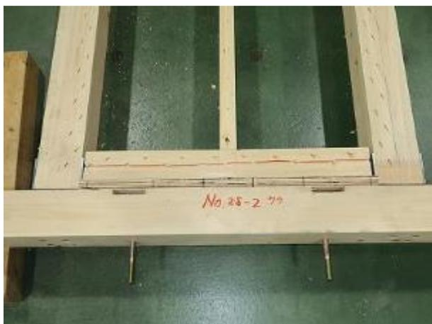
土台側受け材の横方向の割裂
