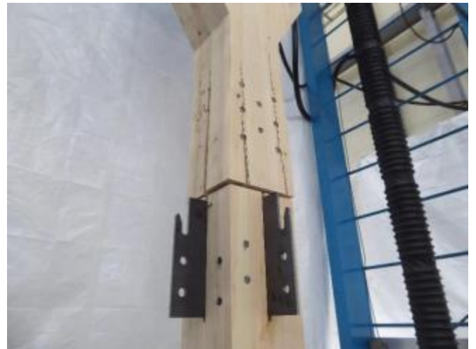
写真9 破壊状況 試験体番号：中間階2
