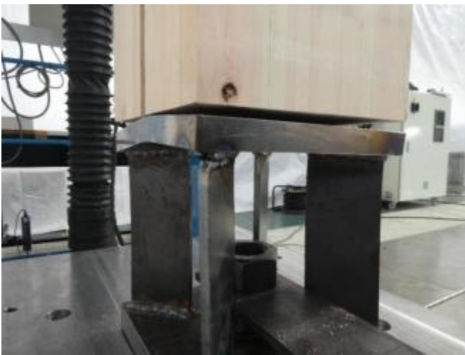
写真4 破壊状況 試験体番号：柱脚3
