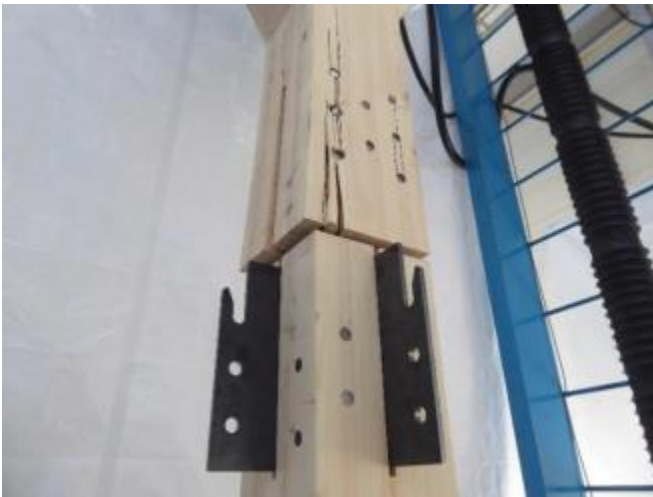
写真8 破壊状況 試験体番号：中間階1
