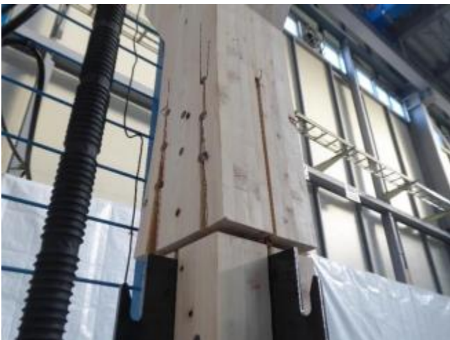
写真12 破壊状況 試験体番号：中間階5
