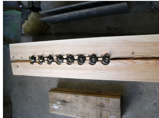
柱の割裂 シアプレートの効果は見られた
