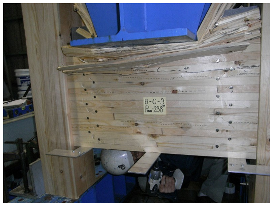
加力中の圧壊の様子
