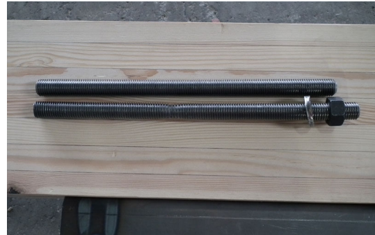
試験後のアンカーボルトの伸び
