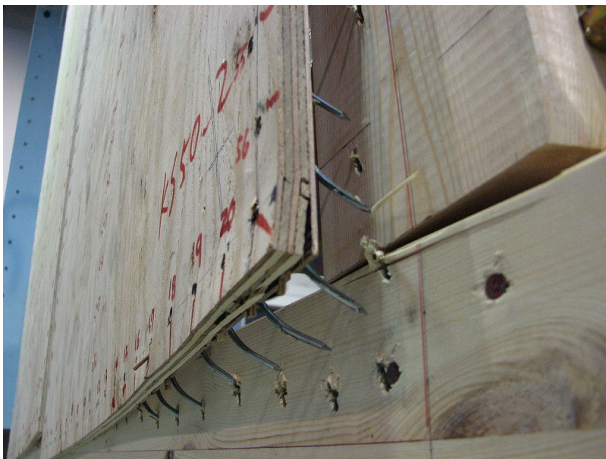
構造用合板の釘の引き抜け
