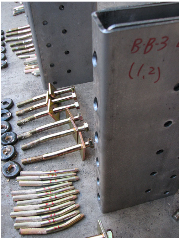
金物本体のボルト穴のわずかな変形 留め付けボルト、ドリフトピンの変形
