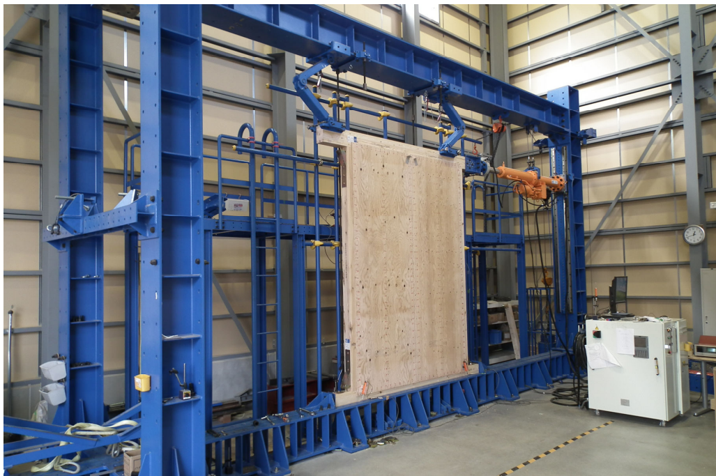
写真 7 面内せん断試験（ハウスプラス確認検査株式会社 横浜試験研センター）
