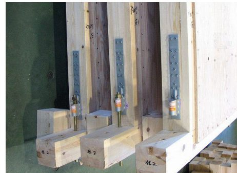
柱脚部への取り付け
