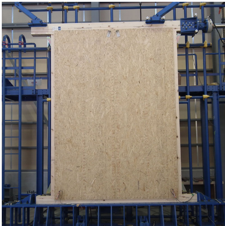
写真 9 構造用パネル (OSB) による耐力壁
