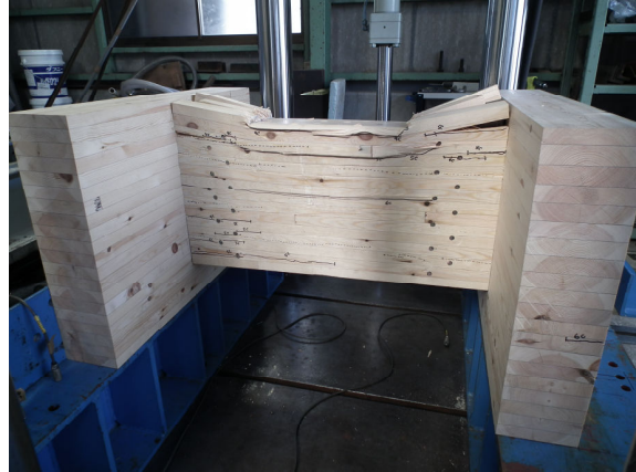
加力部分の大きなめり込み状況
