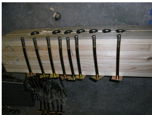
金物固定ボルトの先端に曲げ変形
