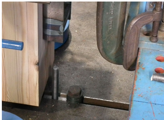
アンカーボルトの破断
