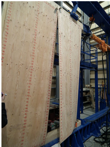
合板・12片-CN65-50の終局状態 構造用合板が面外に孕む。最終加力で軸組の変形が進む過程での現象。
