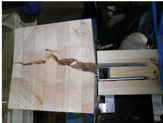
柱の割裂を上から見る
