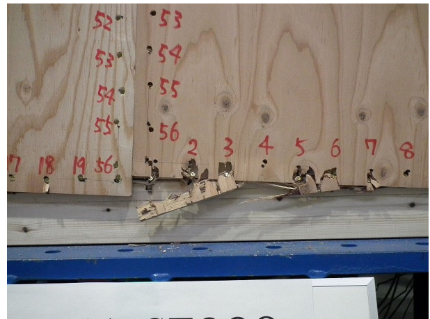
構造用合板の縁切れ
