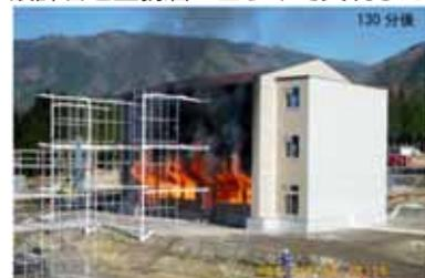
図4 木造三階建学校の実大実験
