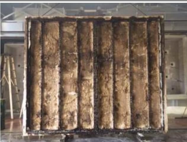
写真 5.2-14 消火後の試験体内部
