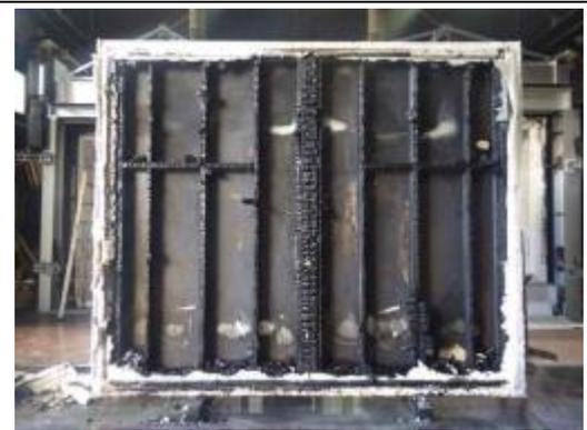
写真 5.2-28 消火後の試験体内部
