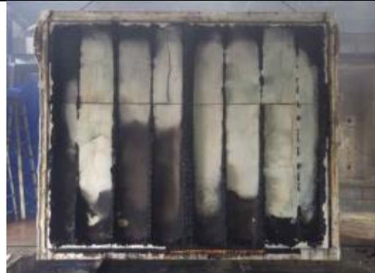
写真 5.2-40 消火後の試験体内部
