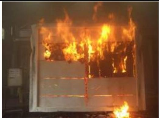
写真 5.2-27 脱炉直後の加熱面
