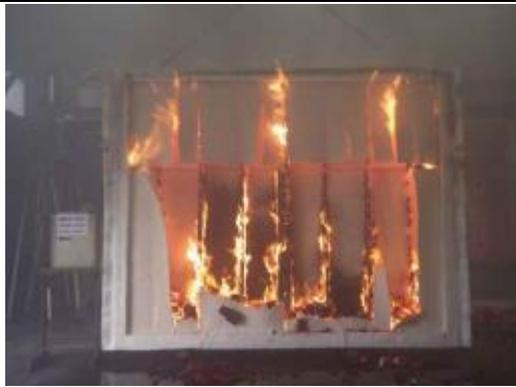
写真 5.2-39 脱炉直後の加熱面
