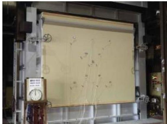
写真 5.2-32 加熱開始時 (非加熱面)
