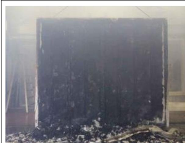
写真 5.2-13 消火直後の加熱面
