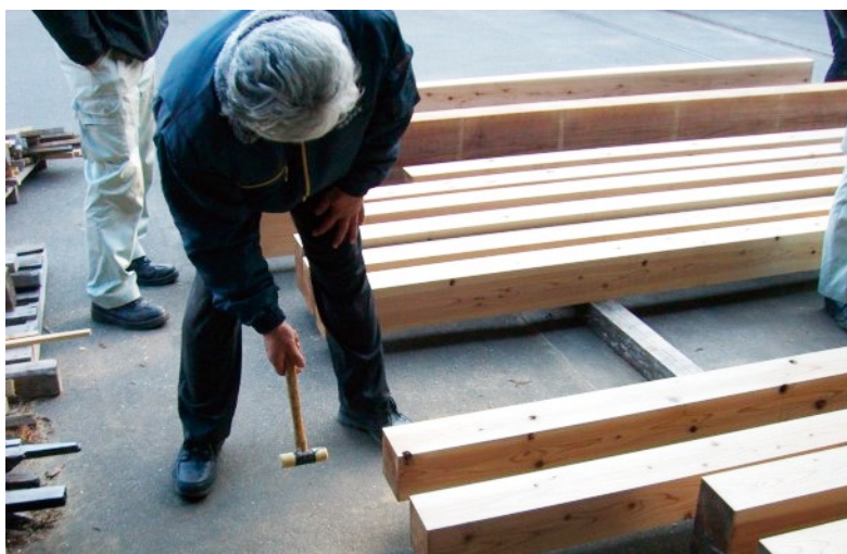
写真4 打撃法によるヤング係数の計測(ハンマーで打撃中)
