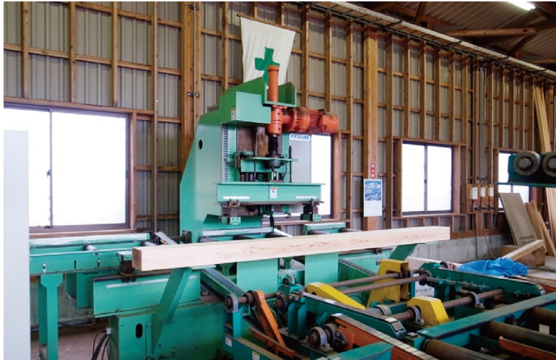
写真5 ヤング係数計測機 (YG-15型)
