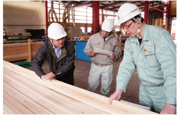
写真2 材料検査(左端が木材コーディネーター)
