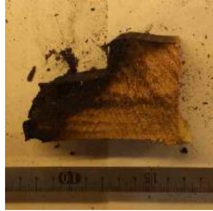
写真 29 試験体 I 下枠(熱電対なし)
