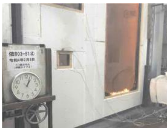
写真 6.2-23 加熱開始 62 分 52 秒 (試験体 J〔大〕：火炎貫通)
