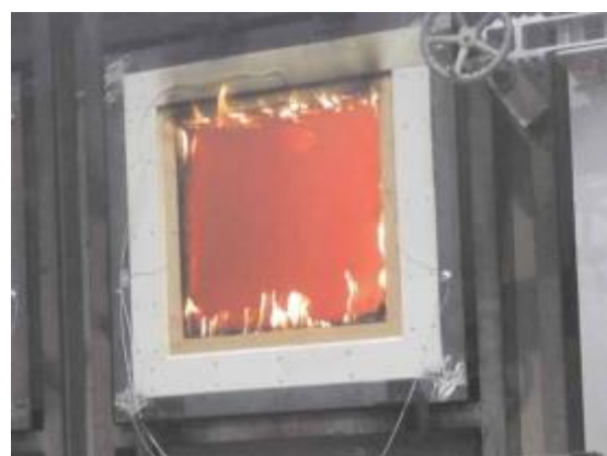
写真 6.2-12 加熱開始 73 分 （試験体 D：屋外側加熱 火炎貫通）
