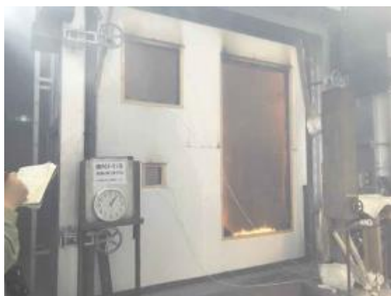
写真 6.2-18 加熱開始 66 分 06 秒 (試験体 G [大]：火炎貫通)
