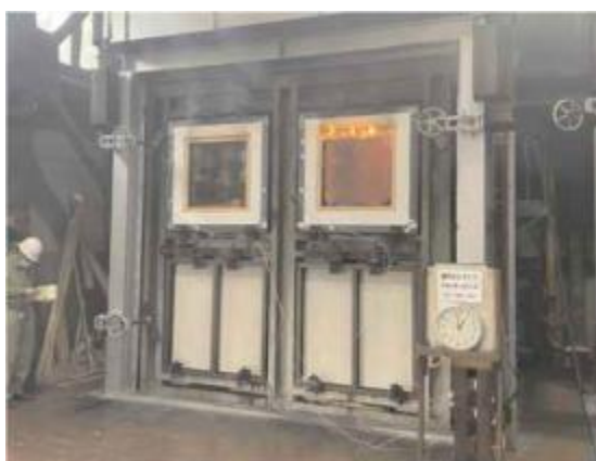
写真 6.2-5 加熱開始 57 分 49 秒 (試験体 A：屋内側加熱 火炎貫通)
