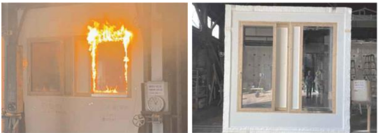
写真 6.1-2 試験体 1 の加熱開始 56 分時の様子 (左) と試験体 4 の加熱前の様子 (右) (試験体 1: 腰窓、試験体 4: 掃き出し窓)
