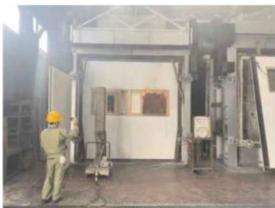
写真 6. 2-29 加熱開始 50 分 48 秒 (試験体 K：火炎貫通)
