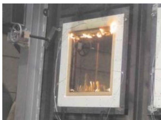
写真 6.2-11 加熱開始 74 分 25 秒 （試験体 C：屋内側加熱 火炎貫通）
