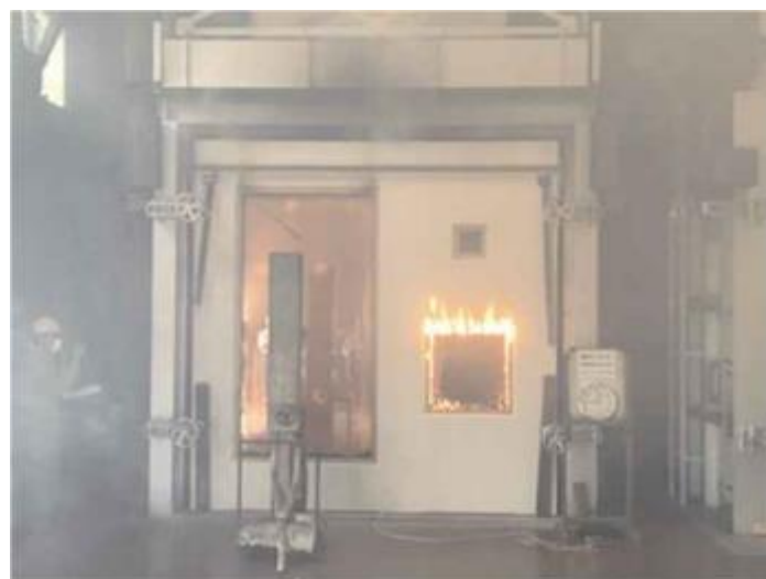
写真 6. 1-1 試験体 A①②③の実験の様子 (加熱 44 分時)
