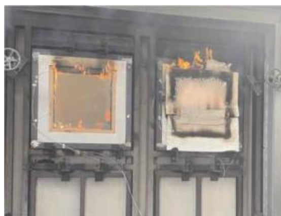
写真 6.2-6 加熱開始 84 分 02 秒 (試験体 B：屋外側加熱 火炎貫通)
