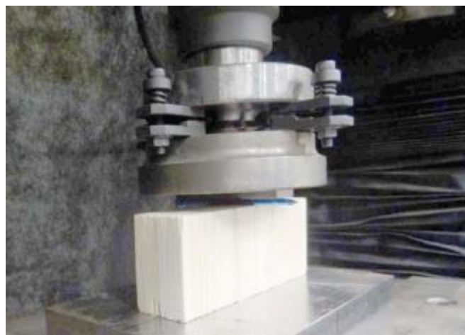
写真-1 試験体設置状況 (例)
