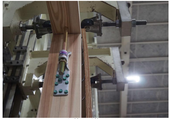
くぎの引抜け
