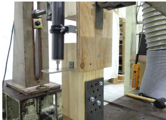
写真-1 【繊維平行方向】試験体設置状況
