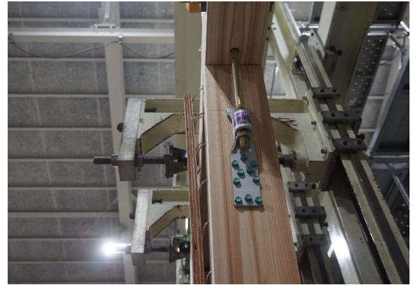
くぎの引抜け
