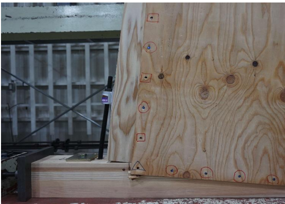
面材の縁切れ、くぎの引抜け
