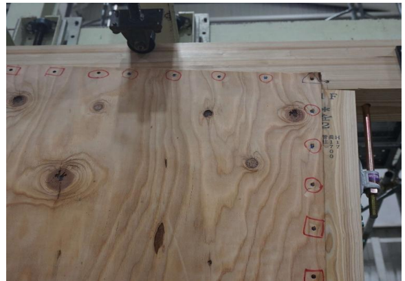
面材の縁切れ、くぎの引抜け
