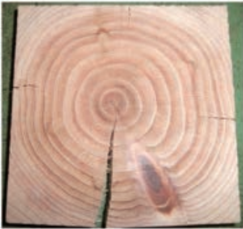
天然乾燥や一般的中温乾燥 では表面割れが発生
