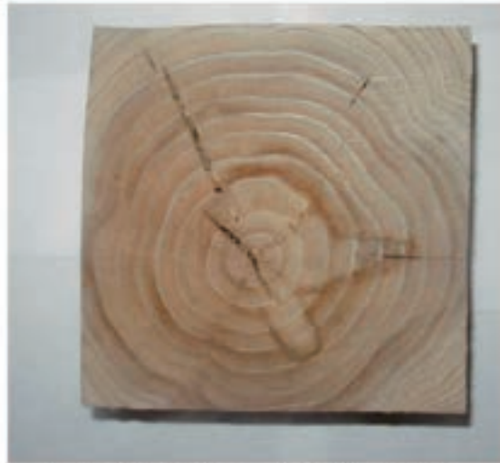
高温低湿乾燥では表面割れ が発生しない
