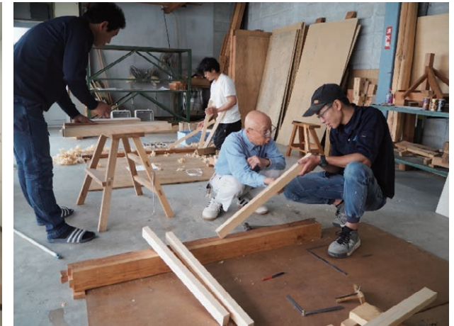
短期訓練 2022年6月19日 建労岡山 若年大工技能向上講習 (現寸図作成及び部材組み立て加工)
