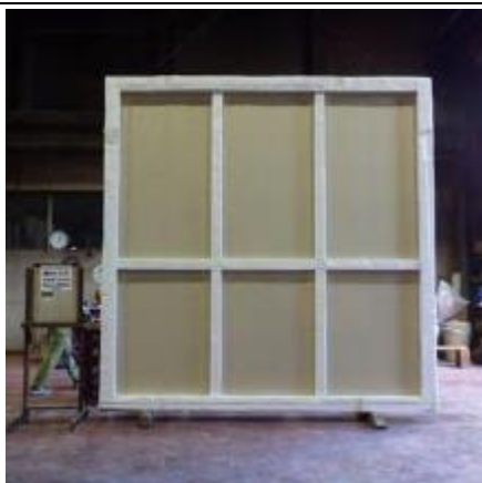
写真 5. 2. 2-3 実験前の加熱面
