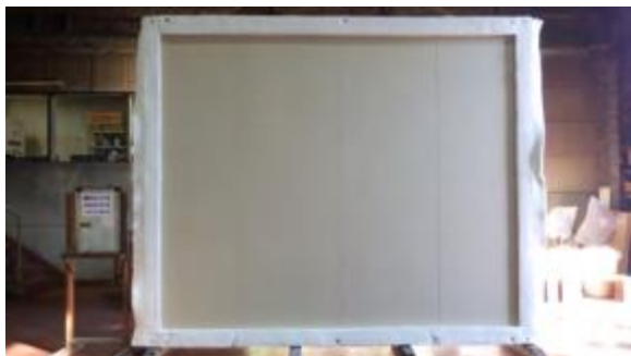
写真 5.3.2-3 実験前の加熱面
