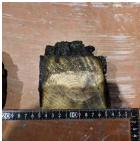
写真 5. 2. 2-20 仕様 6 の柱断面 (熱電対設置位置/見下げ)
