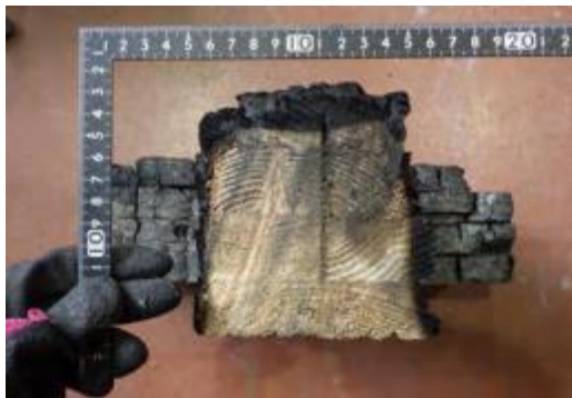
写真 5. 3. 2-33 柱上端から 750mm (熱電対設置位置／見下げ)
