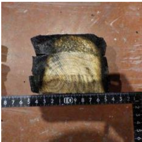
写真 5. 2. 2-19 仕様 5 の柱断面 (熱電対設置位置/見下げ)
