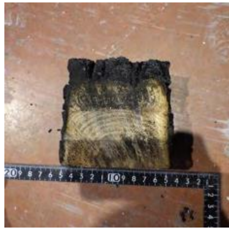
写真 5. 2. 2-16 仕様 2 の柱断面 (熱電対設置位置/見下げ)
