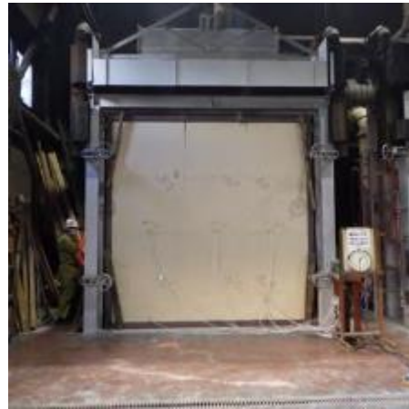
写真 5. 2. 2-10 加熱開始 90 分後 (加熱終了時)
