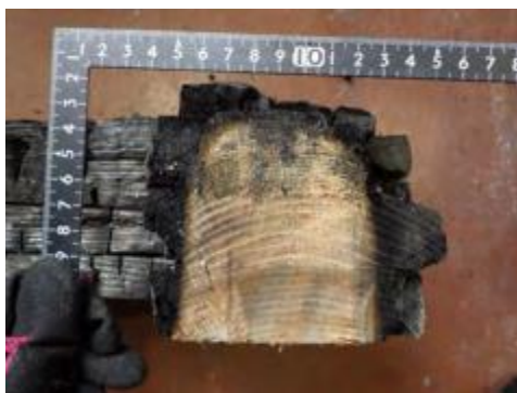
写真 5. 3. 2-35 受け材① (上：加熱側, 下：非加熱側)
