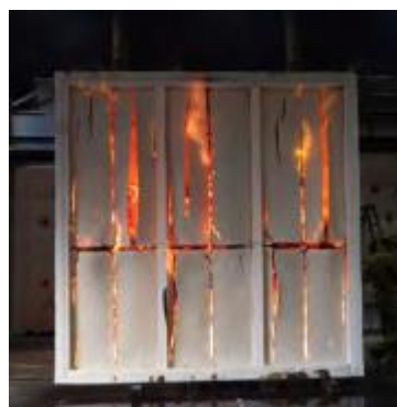
写真 5.2.2-2 実験後 (加熱面・屋外側)
