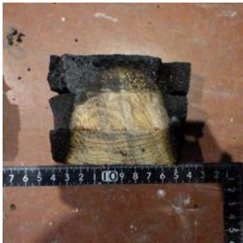
写真 5. 2. 2-17 仕様 3 の柱断面 (熱電対設置位置/見下げ)
