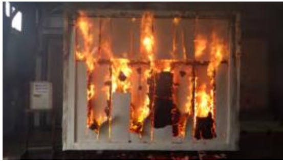
写真 5. 3. 2-29 脱炉直後の加熱面
