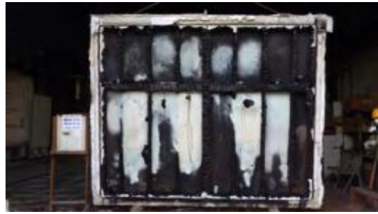
写真 5. 3. 2-30 消火後の試験体内部
