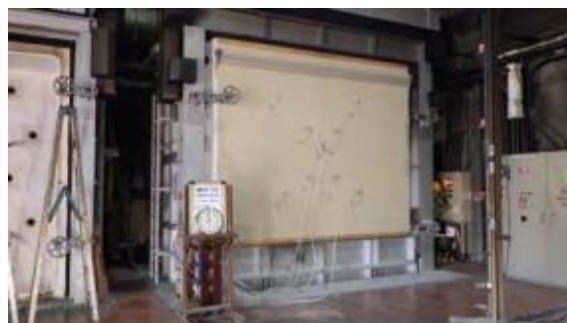
写真 5. 3. 2-22 加熱開始時（非加熱面）
