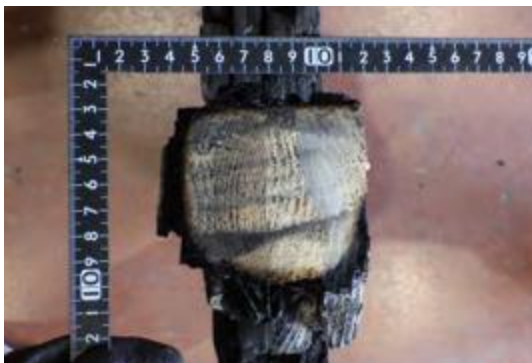
写真 5. 3. 2-17 受け材① (右：加熱側, 左：非加熱側)
