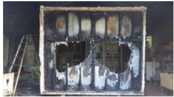
写真 5. 3. 2-12 消火後の試験体内部
