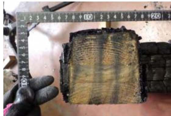
写真 5. 3. 2-36 受け材② (上：加熱側, 下：非加熱側)
