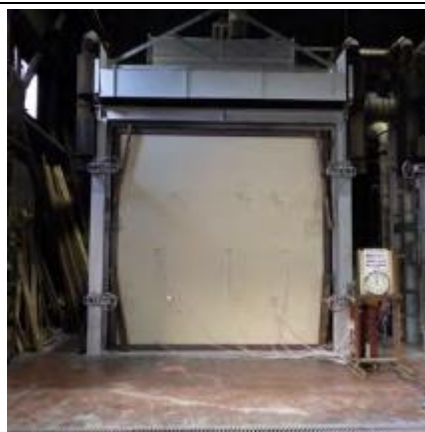
写真 5. 2. 2-4 加熱開始時（非加熱面）
