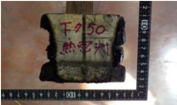
写真 5. 3. 2-15 柱上端から 750mm (熱電対設置位置／見下げ)
