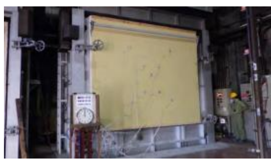
写真 5.3.2-4 加熱開始時 (非加熱面)
