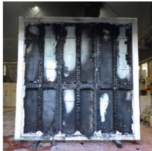
写真 5. 2. 2-12 消火後の試験体内部
