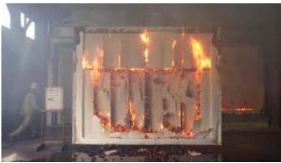
写真 5. 3. 2-11 脱炉直後の加熱面
