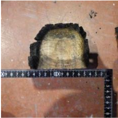
写真 5. 2. 2-15 仕様 1 の柱断面 (熱電対設置位置/見下げ)
