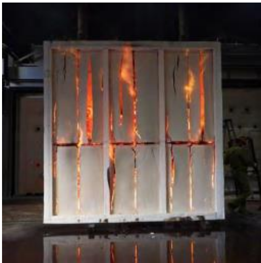
写真 5. 2. 2-11 脱炉直後の加熱面
