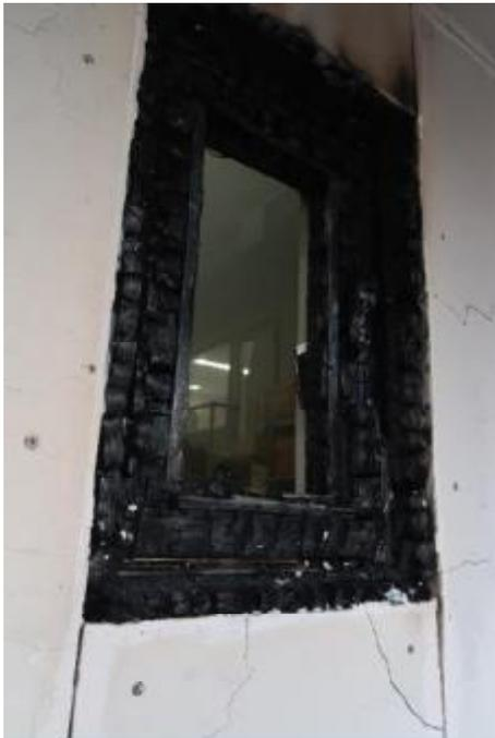
写真 6.2-9 加熱面の状況
