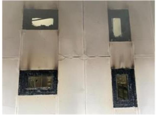
写真 6.2-8 加熱終了後の加熱面
