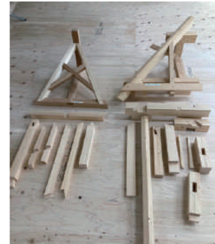
長期・集合訓練 広島県 屋根筋交い課題 ヒヨドリ栓隅木
