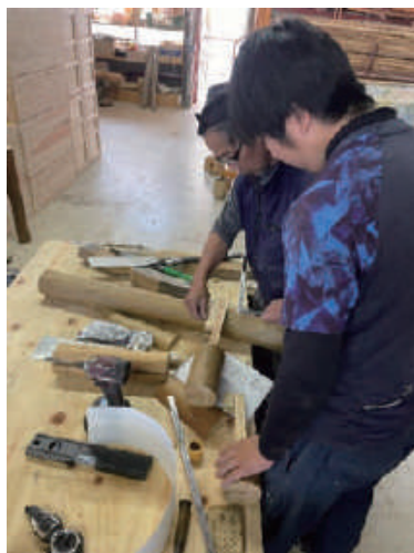
長期・集中訓練 2023年11月4日 フレッセ Lv1(実技) 捻子組の墨付 け及び刻み加工
