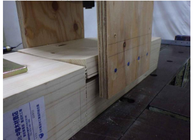
写真 -31 「C _Wk_4_180_30 試験終了後」
