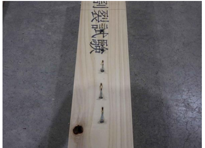
写真-33 「F_Ws_5_@60 解体後」
