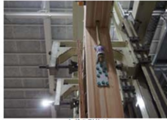
くぎの引抜け
