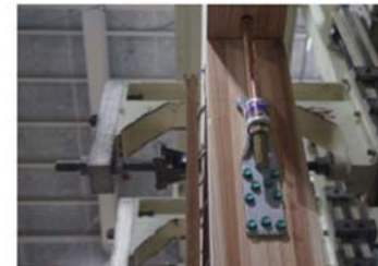
くぎの引抜け
