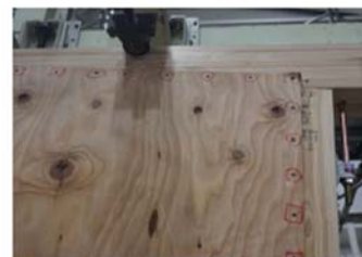
面材の縁切れ、くぎの引抜け
