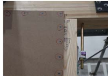
くぎの引抜け
