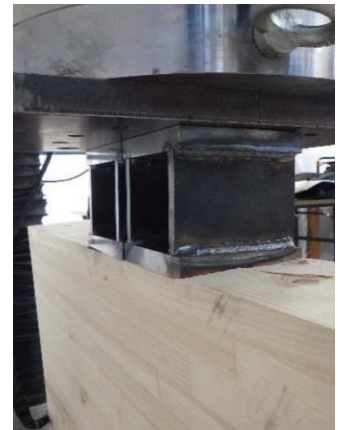
圧縮-2 ; 引きボルトの圧縮座屈、座屈による変位進行による金物の梁へのめり込み
