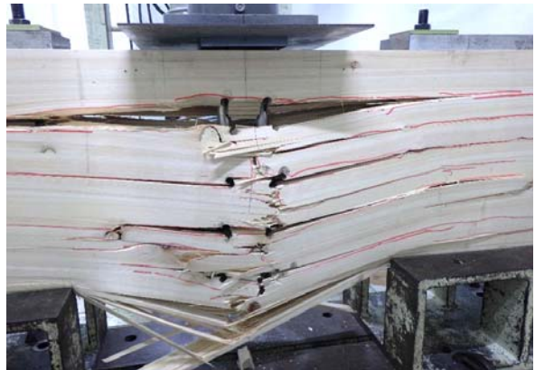
ドリフトピンの変形、支圧による木材の割裂
