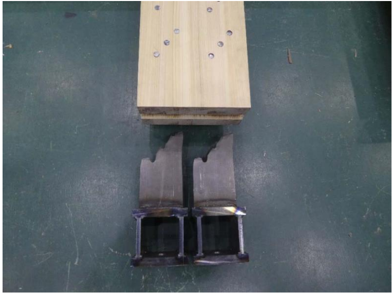
引張-1 ; ドリフトピン位置での木破 引張-2 ; ドリフトピン位置での金物破断
