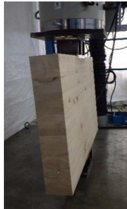
圧縮-2 ; 引きボルトの圧縮座屈、座屈による変位進行による金物の梁へのめり込み
