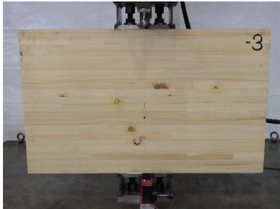
圧縮-3 ; 引きボルトの圧縮座屈、座屈による変位進行による金物の梁へのめり込み
