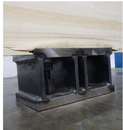
圧縮-3 ; 引きボルトの圧縮座屈、座屈による変位進行による金物の梁へのめり込み
