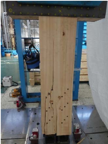
引張-1 ; ドリフトピン位置での木破 引張-2 ; ドリフトピン位置での金物破断
