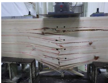
ドリフトピンの変形、支圧による木材の割裂
