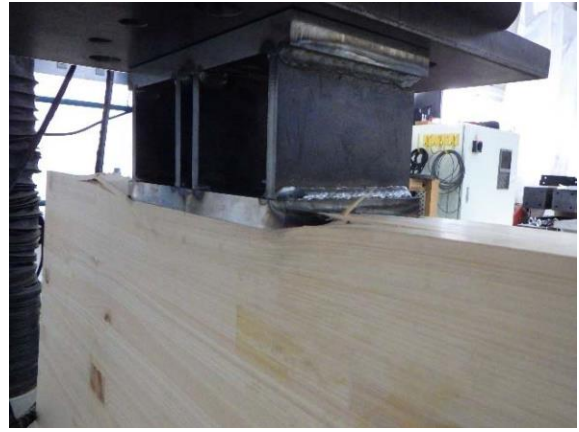
圧縮-1 ; 引きボルトの圧縮座屈、座屈による変位進行による金物の梁へのめり込み
