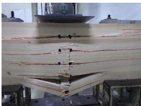
ドリフトピンの変形、支圧による木材の割裂
