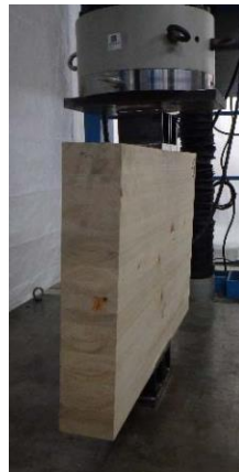
圧縮-3 ; 引きボルトの圧縮座屈、座屈による変位進行による金物の梁へのめり込み
