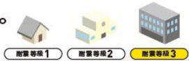
耐震等級1 基本の耐震性能に準拠した建築物 耐震等級2 災害時に被害を受けにくい建築物 耐震等級3 地震発生時に被害を受けにくい建築物
