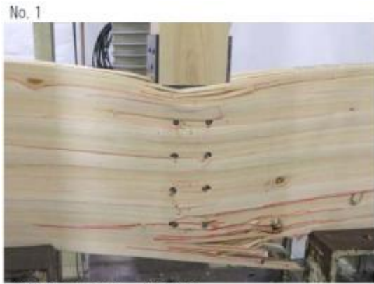
金物のめり込み、桁の割れ
