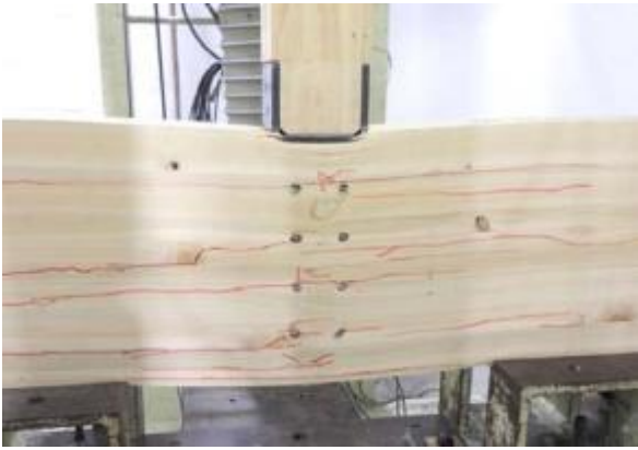
金物のめり込み、桁の割れ
