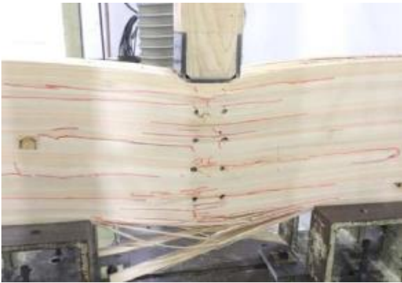
金物のめり込み、桁の割れ
