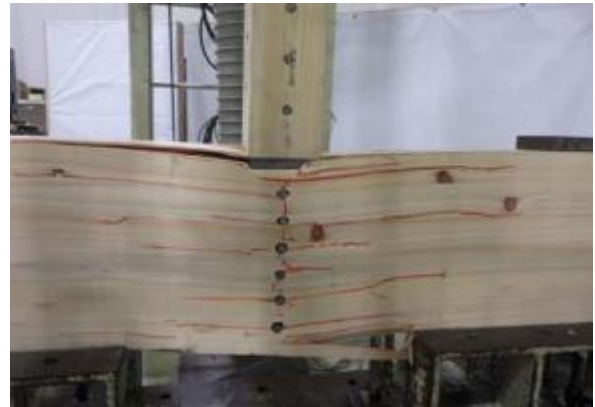
金物のめり込み、桁の割れ
