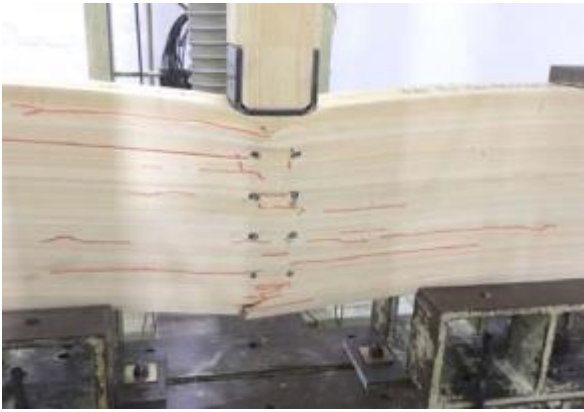
金物のめり込み、桁の割れ
