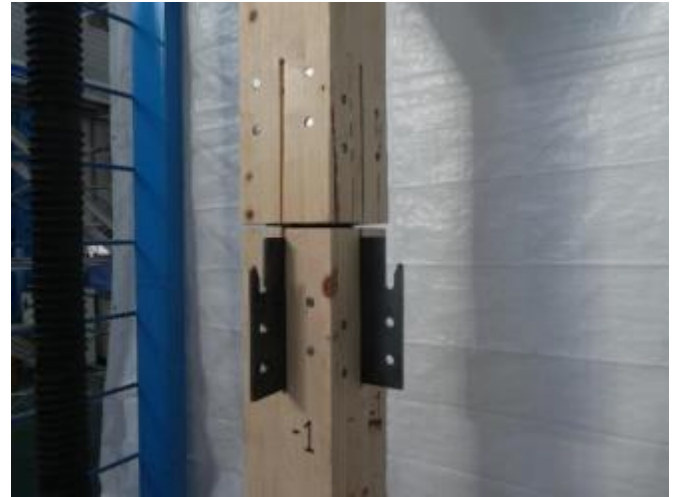
写真9 破壊状況 試験体番号：中間階1
