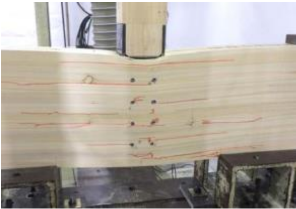
金物のめり込み、桁の割れ
