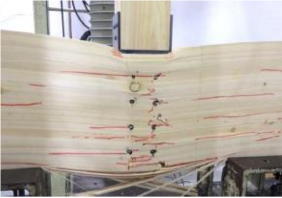
金物のめり込み、桁の割れ
