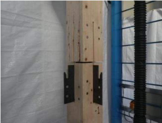
写真8 破壊状況 試験体番号：中間階1
