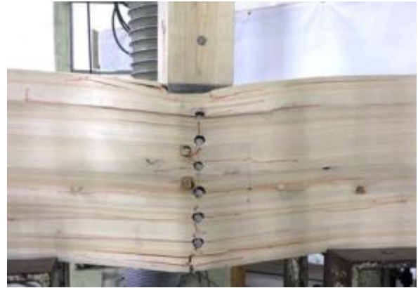
金物のめり込み、桁の割れ
