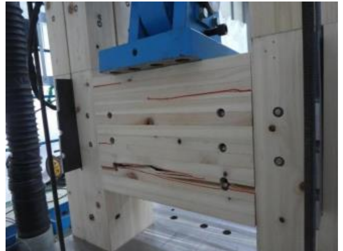
写真11 破壊状況 試験体番号：梁受け0
