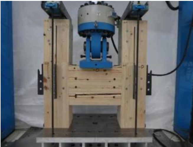
写真10 破壊状況 試験体番号：梁受け0
