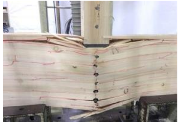
金物のめり込み、桁の割れ
