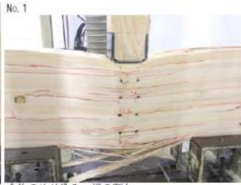
金物のめり込み、桁の割れ
