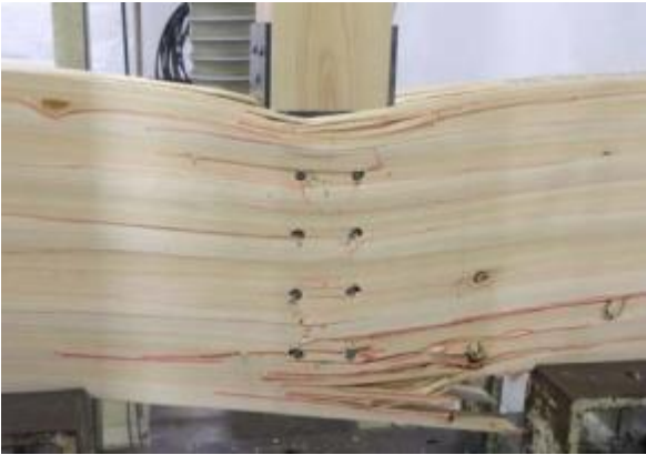
金物のめり込み、桁の割れ
