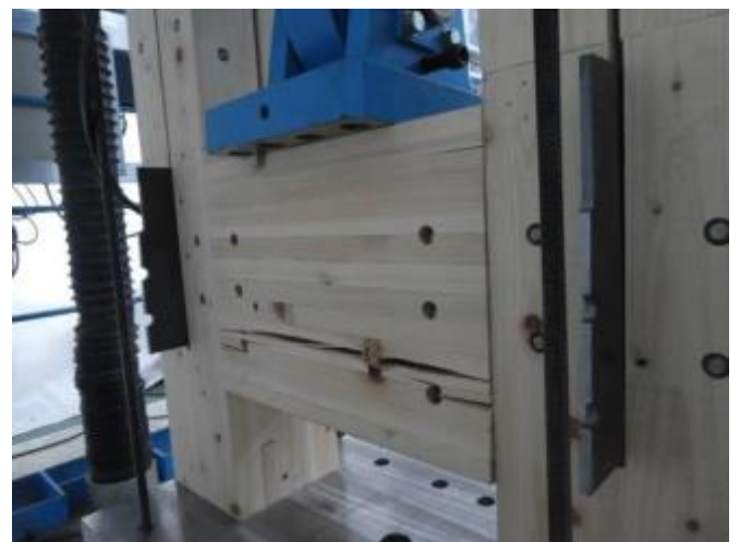
写真13 破壊状況 試験体番号：梁受け1
