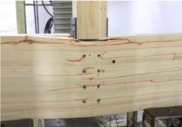
金物のめり込み、桁の割れ
