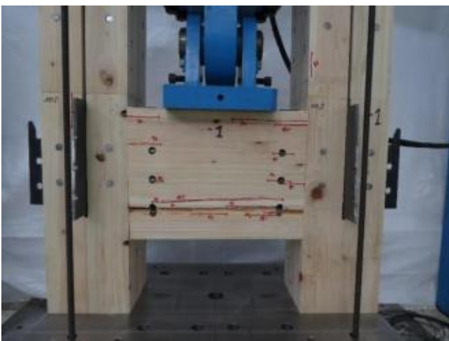
写真12 破壊状況 試験体番号：梁受け1
