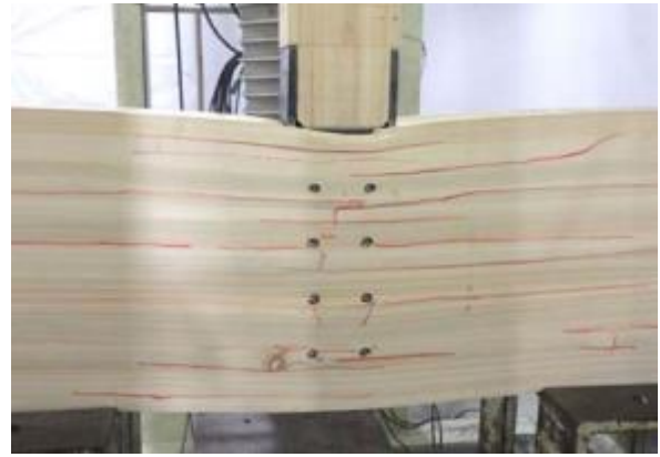
金物のめり込み、桁の割れ
