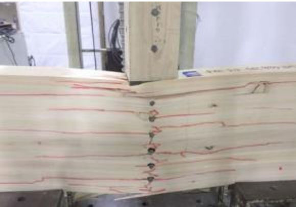
金物のめり込み、桁の割れ
