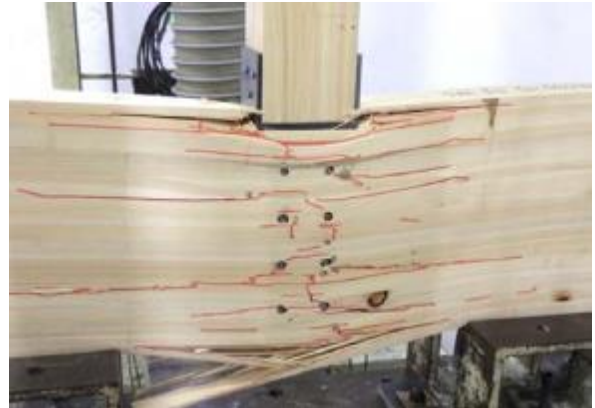
金物のめり込み、桁の割れ
