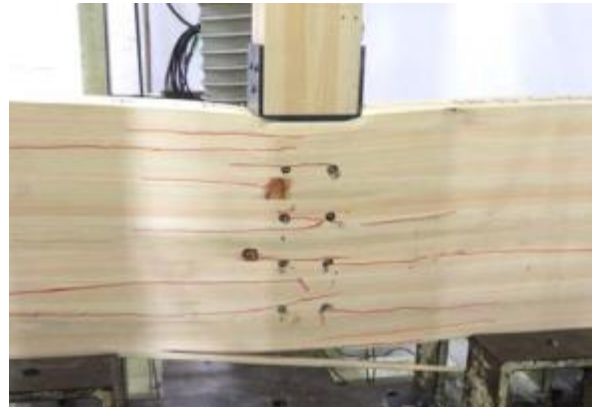
金物のめり込み、桁の割れ
