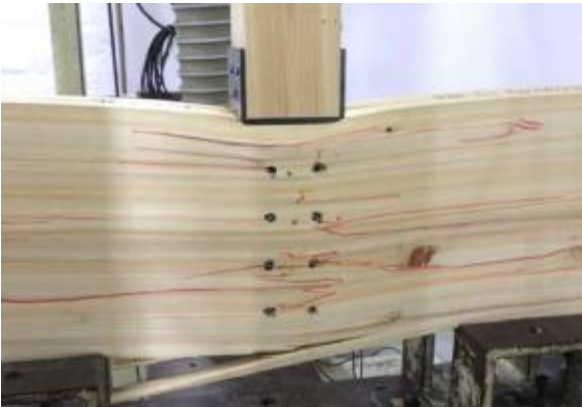
金物のめり込み、桁の割れ
