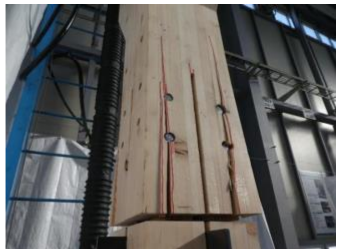
写真7 破壊状況 試験体番号：中間階0
